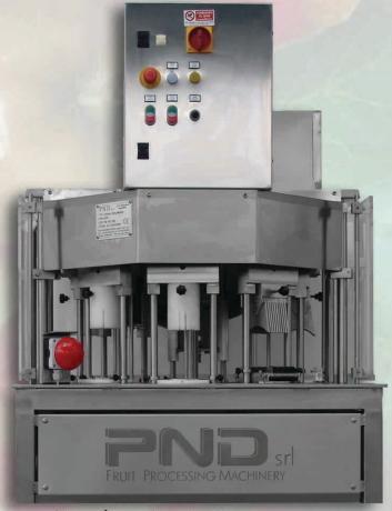
La macchina è realizzata interamente in acciaio Inox. Già alla costruzione è stato ritenuto importante che tutti i componenti della macchina fossero facilmente intercambiabili ed in caso di manutenzione o pulizia si potesse avere facile accesso alle parti corrispondenti e lavorare senza problemi.
